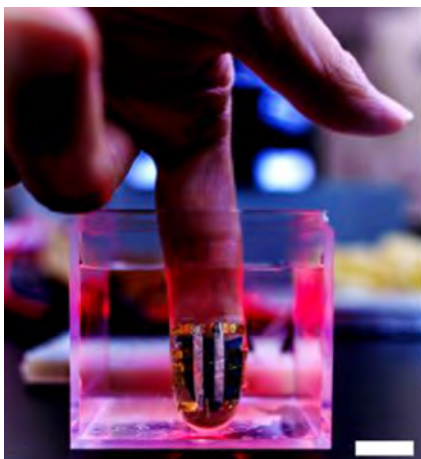
図1：水中で動作可能な有機光学式センサ
